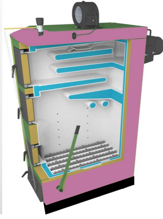
konstrukcja przystosowana do „górnego spalania”
